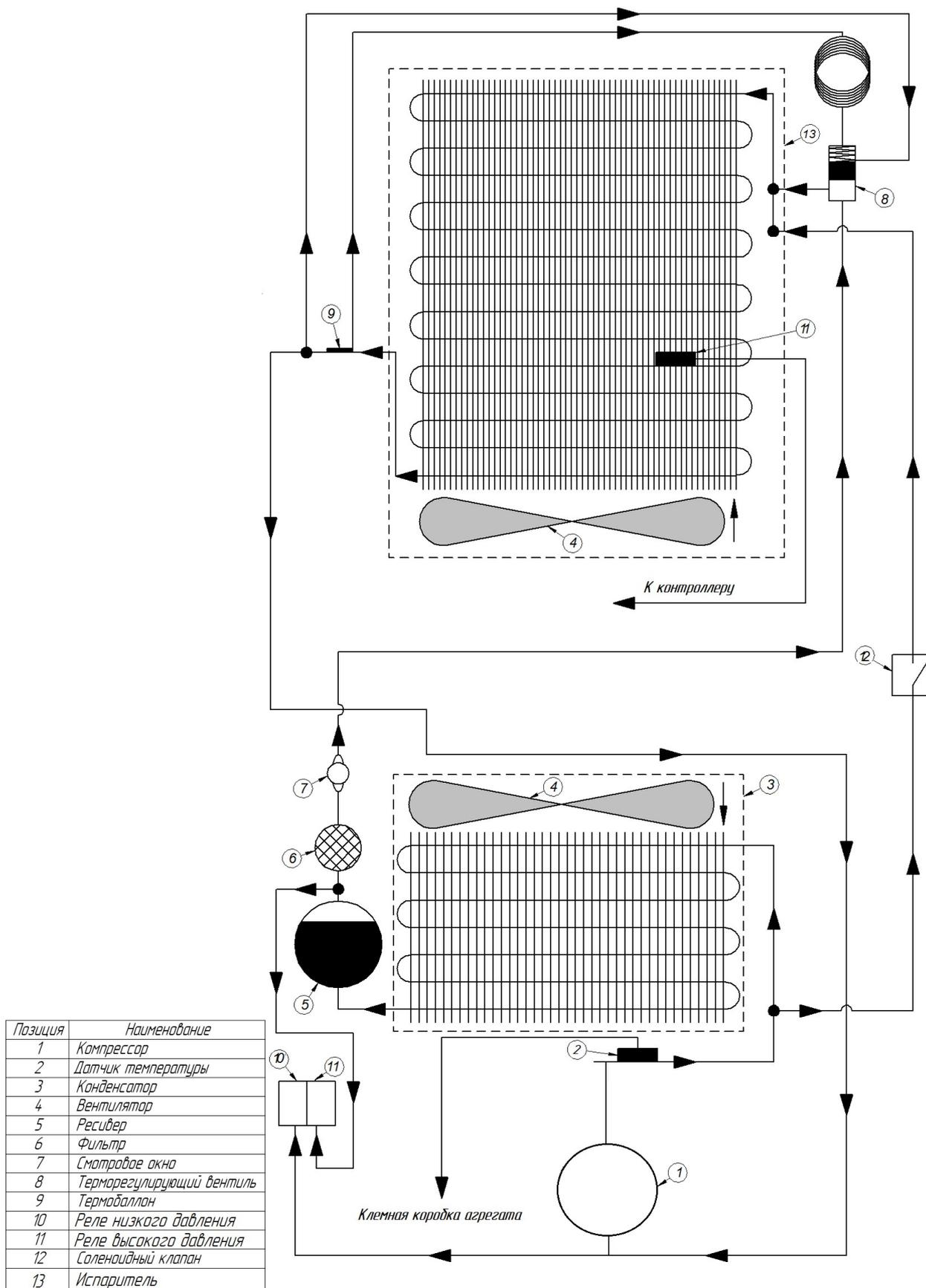
Рис.2 Принципиальная схема системы охлаждения
